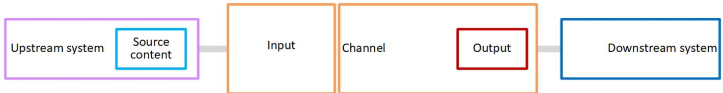
Um mit der Verarbeitung der Inhalte zu beginnen, starten Sie den Kanal. Wenn der Channel ausgeführt wird, nimmt er die Quellinhalte aus dem Upstream-System auf, das von der Eingabe identifiziert wird. Der Kanal transkodiert dann das Video (und die zugehörigen Audiodateien, Untertitel und Metadaten) und erstellt Ausgaben. MediaLive sendet die Ausgaben an die angegebenen Downstream-Systeme.
