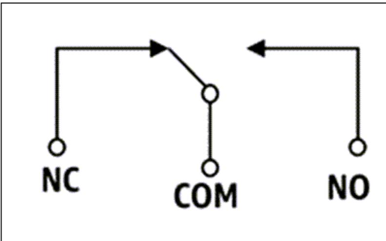
Das Relais sollte gemäß den angegebenen Sicherheitsklassen 30 VAC /60VDC, max. 60 W betrieben werden.
