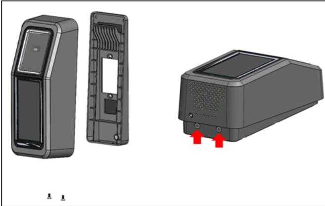
3. Positionieren Sie die Montageplatte an der gewünschten Stelle an der Wand. Verwenden Sie die Halterung als Schablone, um die äußeren sechs Schraubenlöcher zu markieren, wie in der folgenden Abbildung gezeigt.
