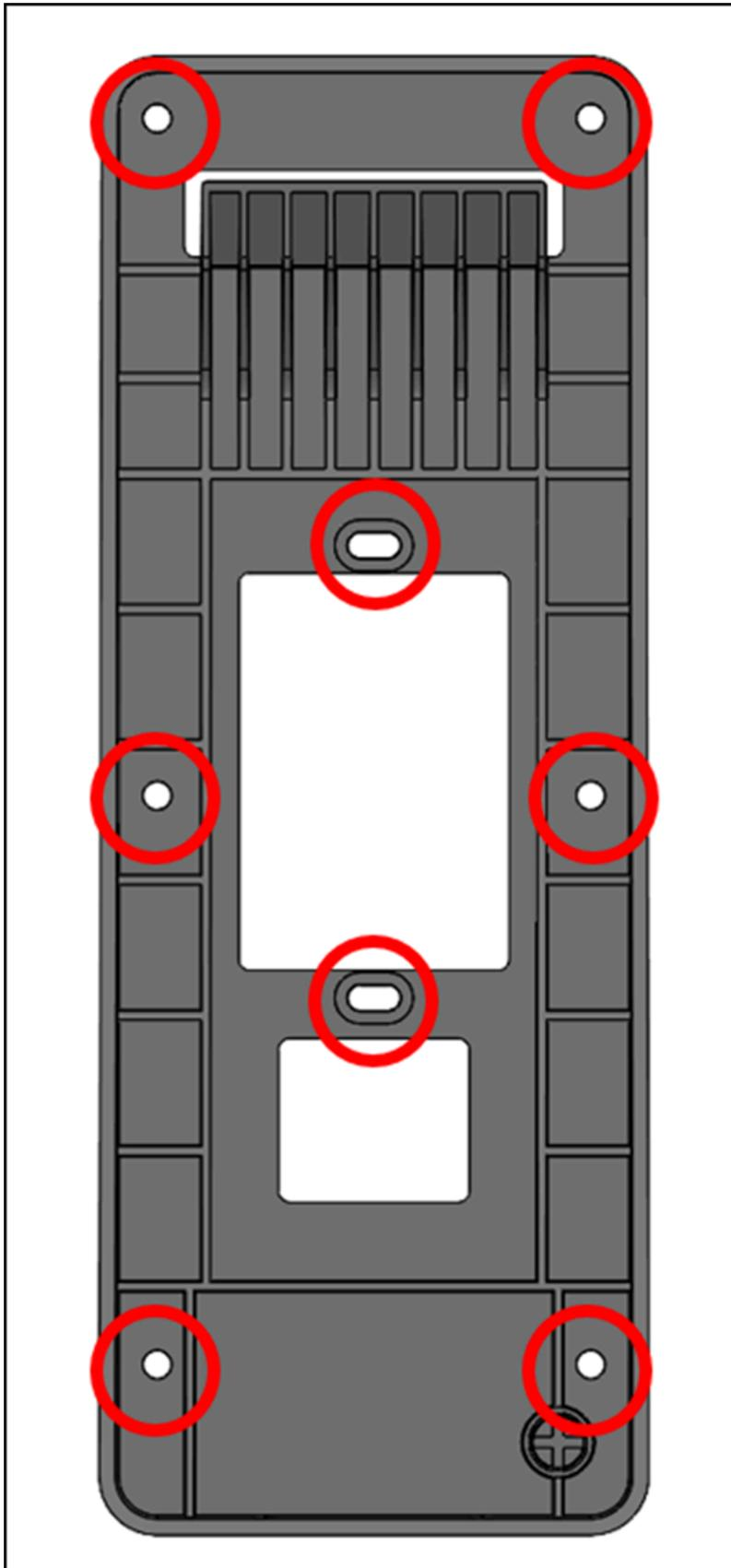
4. Bei der Montage in Stuck-, Trockenbau-, Ziegel- oder Betonoberflächen bohren Sie an jeder markierten Stelle 1/4-Zoll-Löcher und bringen Sie dann Wandanker an, indem Sie sie in das Loch drücken, bis der Dübel bündig mit der Wand abschließt.
