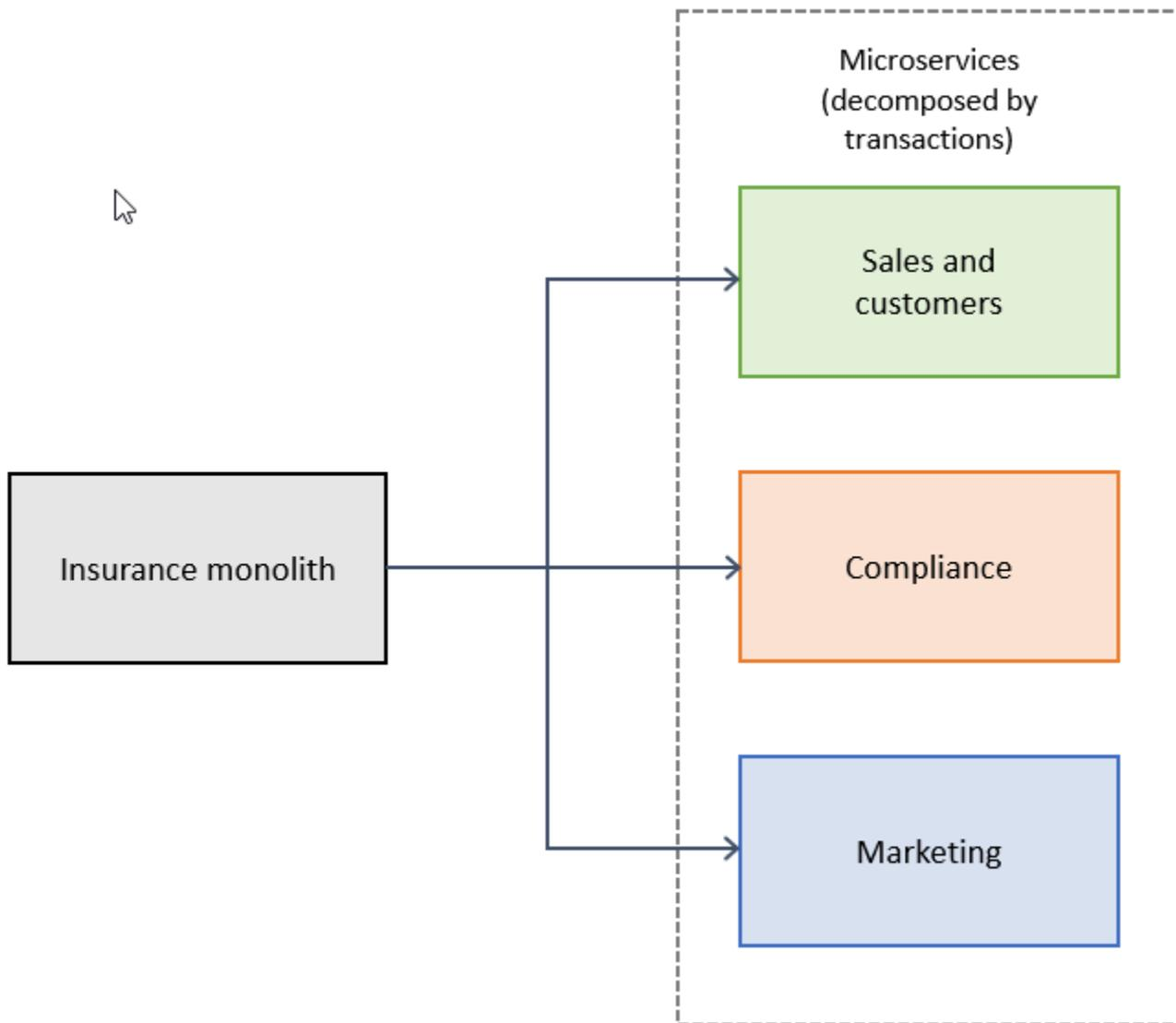
In einem Versicherungssystem wird eine Schadenanfrage in der Regel einem Kunden angezeigt, nachdem sie eingereicht wurde. Das bedeutet, dass ein Schadenservice ohne einen Microservice für Kunden nicht existieren kann. Vertrieb und Kunden sind in einem Microservice-Paket zusammengefasst, und eine Geschäftstransaktion erfordert die Abstimmung mit beiden.
