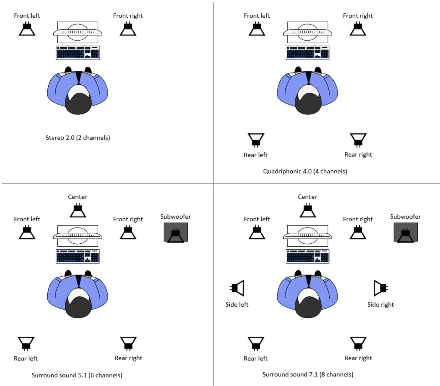
Si el cliente solicita un número de canales de audio inferior al número de canales proporcionado por el servidor, el servidor mezcla automáticamente el número de canales. Este debe coincidir con el número de canales solicitado por el cliente. Por ejemplo, supongamos que el cliente solicita sonido envolvente 5.1 mientras que el servidor admite sonido envolvente 7.1. El servidor mezcla automáticamente el audio hasta 5.1.
