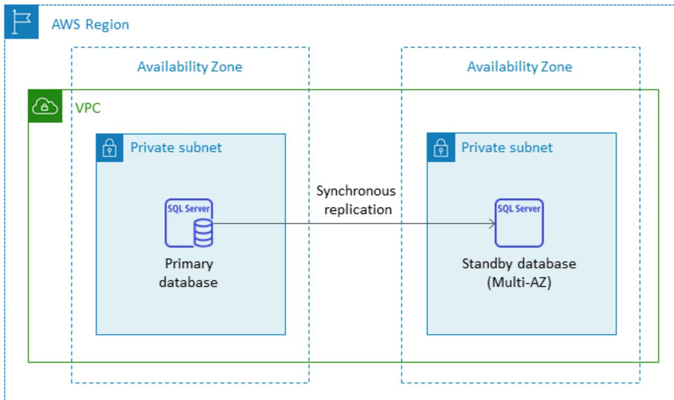
Al configurar SQL Server en una configuración multi-AZ, Amazon RDS configura automáticamente la instancia de base de datos en espera mediante la duplicación de la base de datos o los grupos de disponibilidad Always On, en función de la versión de SQL Server que implemente. Las versiones y ediciones específicas de SQL Server se enumeran en la [documentación de Amazon RDS](#).
