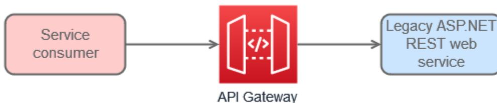
Cuando el proxy de API Gateway esté instalado, puede crear e implementar el servicio modernizado utilizando Amazon ECS, AWS por ejemplo, para lograr un servicio altamente escalable y disponible. Cuando se hayan creado y probado el proxy y el servicio recientemente modernizado, puede volver a configurar el endpoint de API Gateway para que apunte a la API REST modernizada para su implementación.
