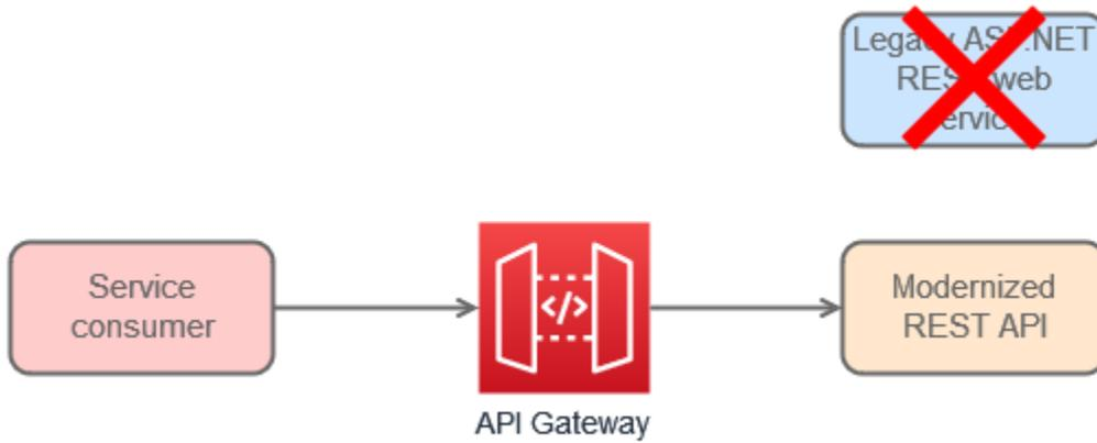
Si el servicio recién modernizado tiene un contrato de API diferente del contrato de proxy antiguo del que dependen los sistemas consumidores, puede utilizar la función de transformación de datos de API Gateway. Las solicitudes de API entrantes que se estructuran mediante el esquema del sistema heredado se pueden mapear y transformar en el contrato del nuevo servicio.
