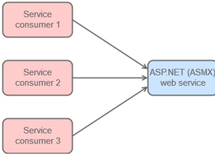
Como estos consumidores llaman al servicio ASMX mediante el protocolo SOAP, reemplazar el servicio ASMX por una API REST provocaría que estos consumidores se quedarán sin trabajo. Además, la refactorización del servicio ASMX a una API REST al convertir el sistema de una arquitectura monolítica a microservicios probablemente implicará remodelar el comportamiento del sistema y el modelo de dominio. Es probable que esto genere cambios importantes adicionales para los consumidores.
