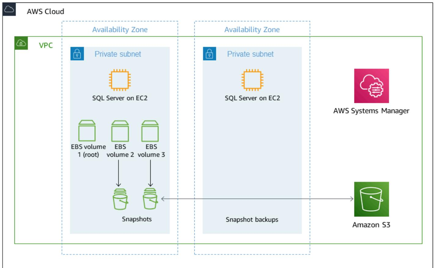
Esta arquitectura utiliza AWS Systems Manager Run Command para instalar el agente VSS en las instancias de SQL Server. También puede utilizar Run Command para invocar todo el flujo de trabajo consistente en vaciar búferes del sistema operativo y aplicaciones en el disco, pausar las operaciones de E/S, tomar una instantánea puntual de los volúmenes de EBS y, a continuación, reanudar la E/S.
