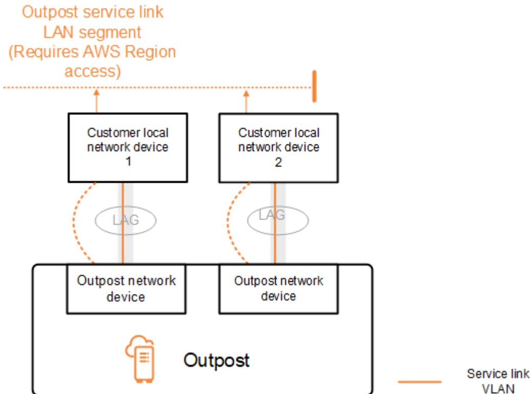
L'Outpost établit une session d'appairage BGP externe via le VLAN de liaison de service en utilisant le processus suivant :
