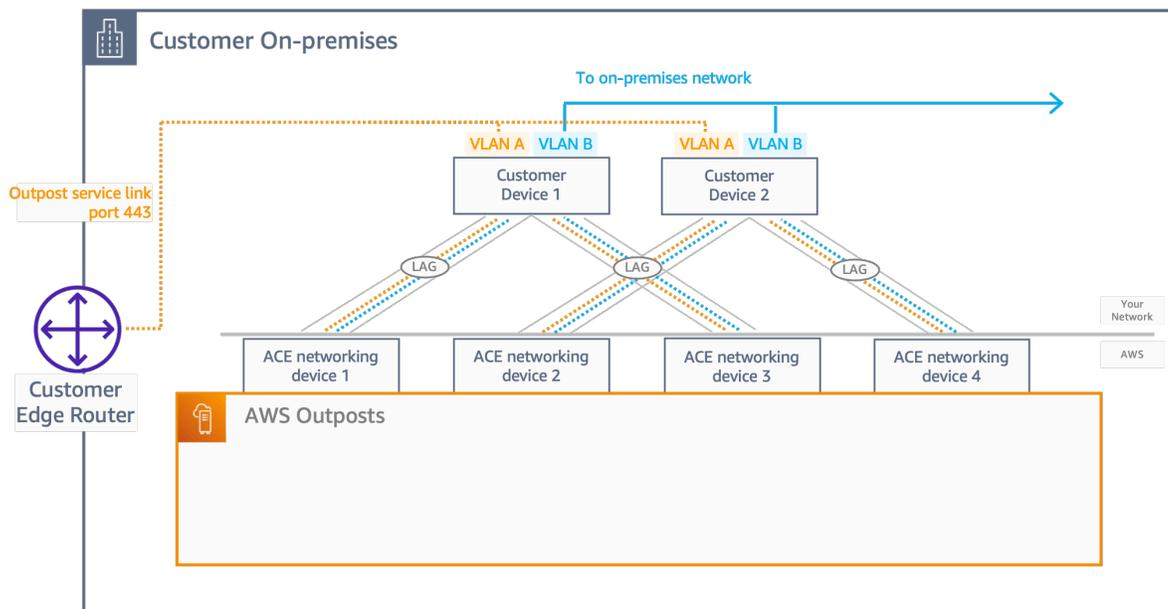
L'image suivante montre les quatre périphériques réseau ACE du rack ACE connectés à quatre appareils clients en amont :
