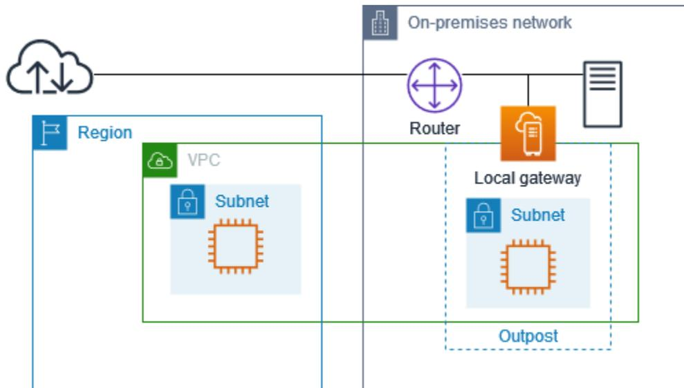
Pour établir une connectivité Internet via le réseau sur site, la table de routage du sous-réseau Outpost doit comporter les routes suivantes.
