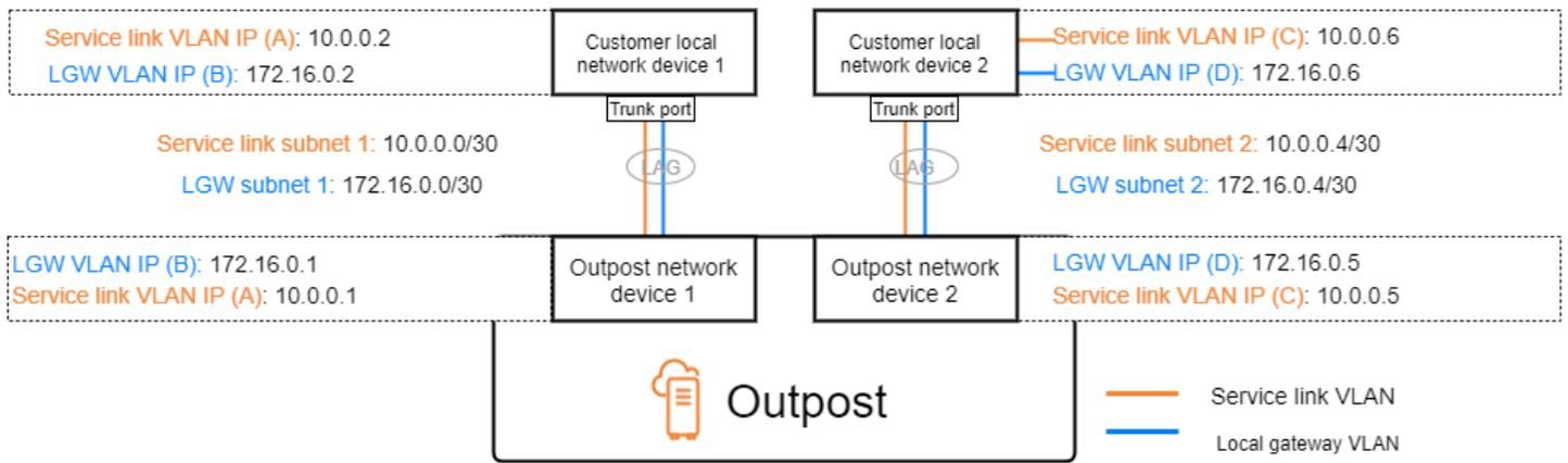
Le tableau suivant présente des exemples de valeurs pour les sous-réseaux qui connectent le périphérique réseau Outpost 1 au périphérique réseau local 1 du client.
