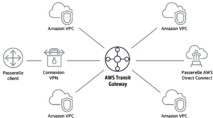
Figure 2 : Avec AWS Transit Gateway, il vous suffit de connecter chaque Amazon VPC ou VPN à AWS Transit Gateway pour acheminer le trafic vers et depuis chaque VPC ou VPN.
