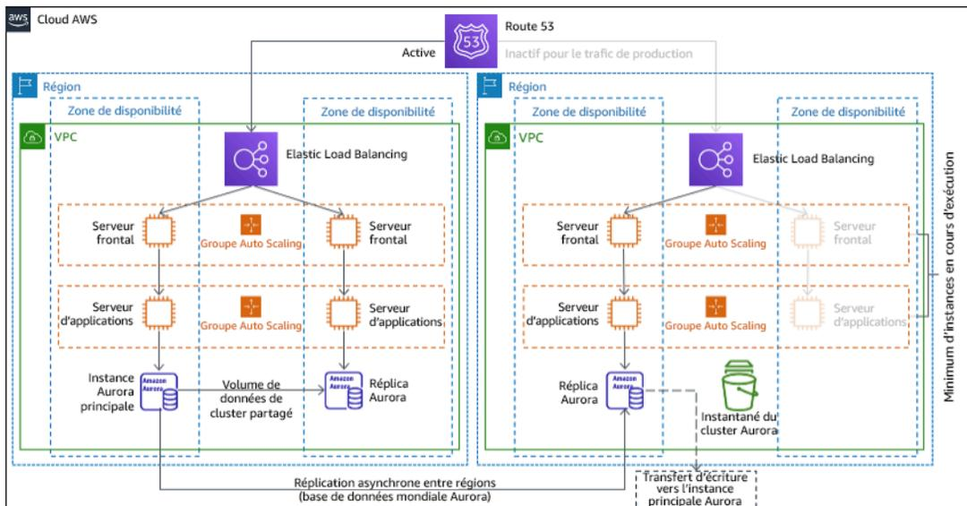
Figure 21 : Architecture de secours à chaud
