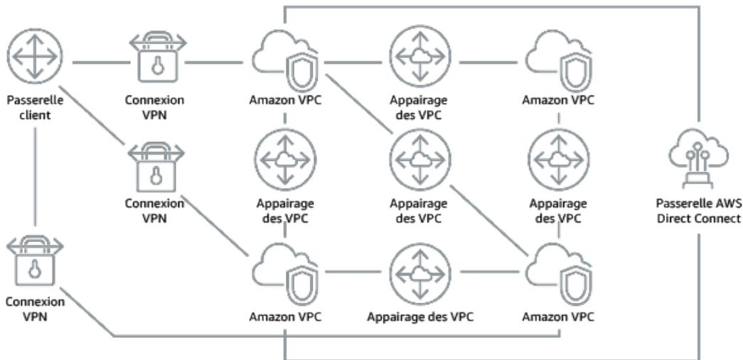
Figure 1 : Sans AWS Transit Gateway, vous devez appairer chaque Amazon VPC l'un à l'autre et à chaque emplacement sur site à l'aide d'une connexion VPN, ce qui peut devenir complexe à mesure que votre système se développe.
