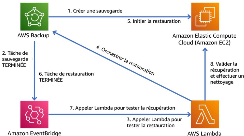
Figure 9 : Processus de sauvegarde et de restauration automatisé
