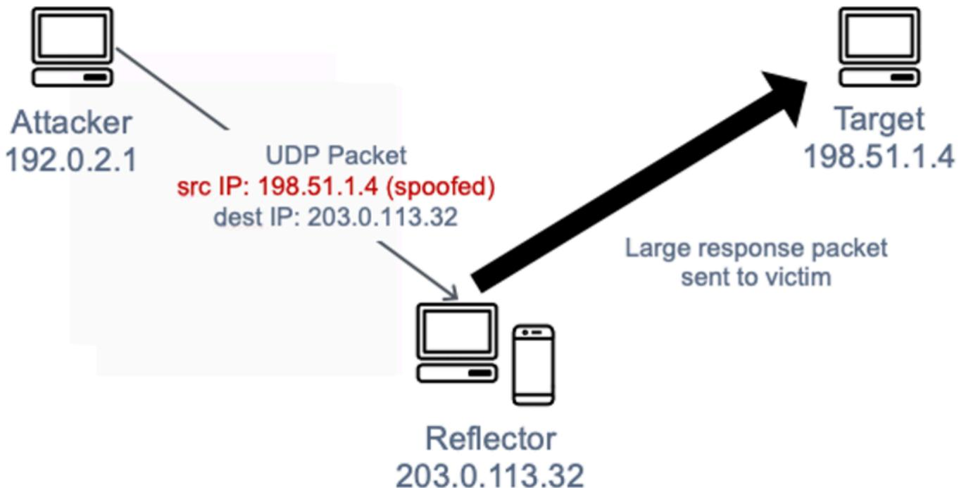
Schéma illustrant une attaque par UDP réflexion
