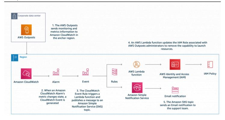
Gérer AWS Outposts capacité avec Amazon CloudWatch et AWS Lambda
