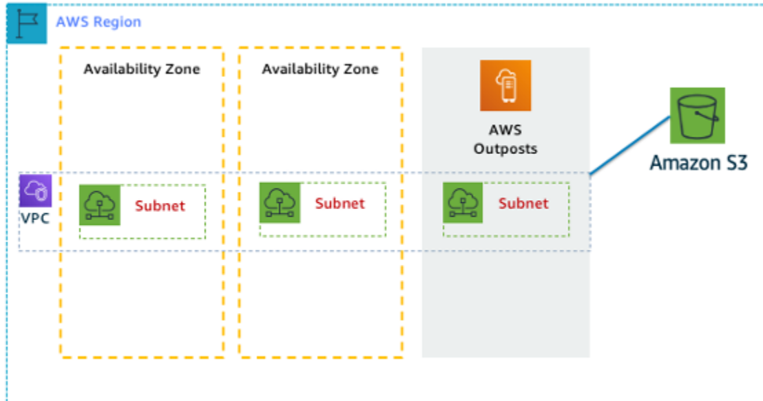
Gambar 1: Contoh arsitektur AWS Outposts
