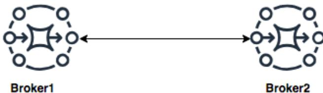
Con un connettore di rete duplex, i messaggi vengono inoltrati da ciascun broker all'altro. Questi sono inoltrati on demand: se c'è un consumatore su Broker2 per un messaggio su Broker1, il messaggio viene inoltrato. Similmente, se c'è un consumatore su Broker1 per un messaggio su Broker2, il messaggio viene ugualmente inoltrato.
