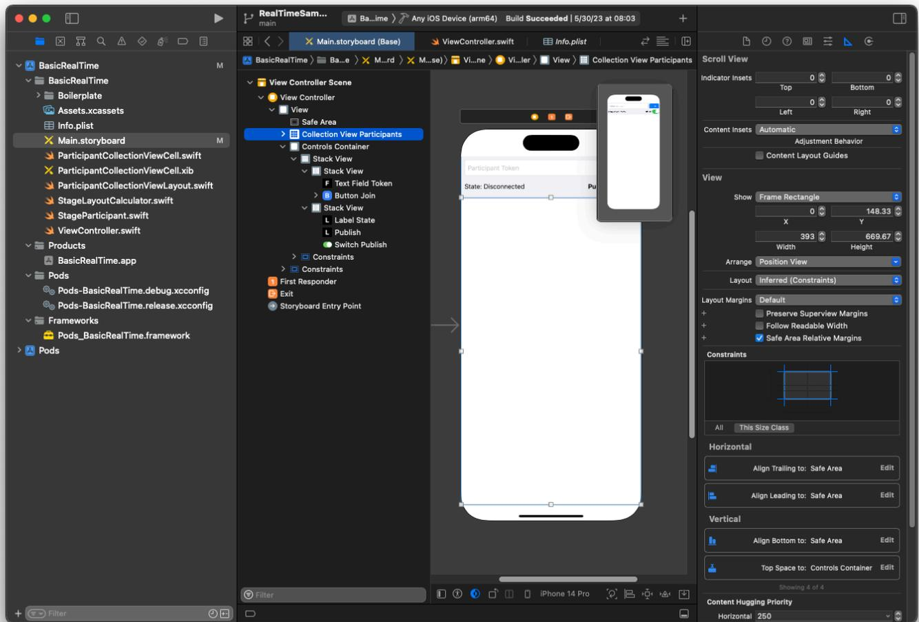
La seconda vista è Container controlli. Collegato Iniziale, Finale e In alto a Area sicura.
