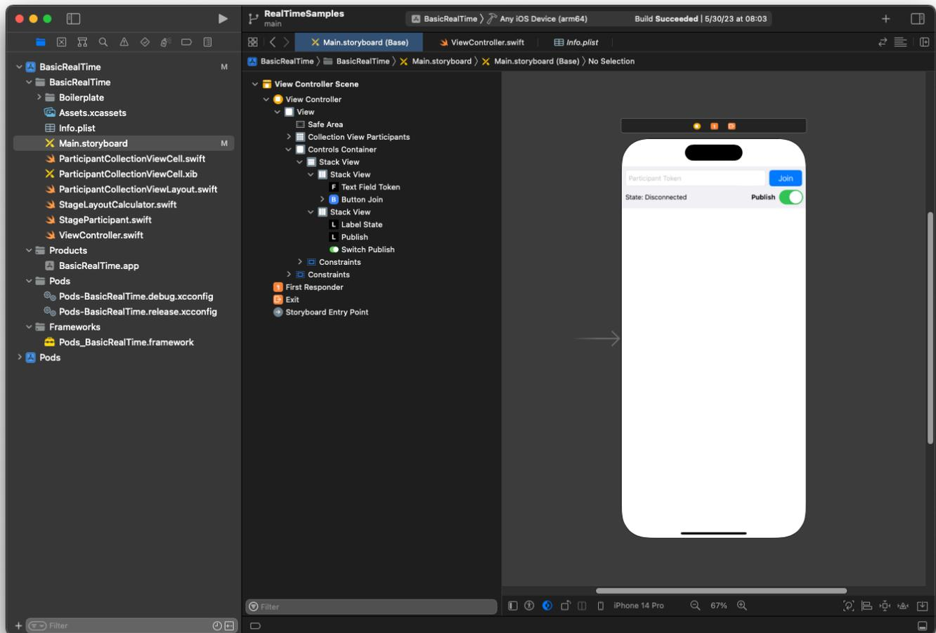
Per la configurazione di AutoLayout, dobbiamo personalizzare tre viste. La prima vista è Partecipanti della vista Raccolta (UICollectionView). Collegato Iniziale, Finale e In basso a Area sicura. Collegato anche In alto a Container controlli.
