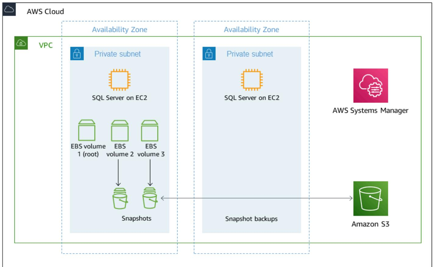
Questa architettura utilizza il comando AWS Systems Manager Run per installare l'agente VSS sulle istanze SQL Server. È inoltre possibile utilizzare il comando di esecuzione per richiamare l'intero flusso di lavoro che consiste nel trasferire i buffer del sistema operativo e delle applicazioni sul disco, sospendere le operazioni di I/O, eseguire uno snapshot point-in-time dei volumi EBS e poi riprendere l'I/O.
