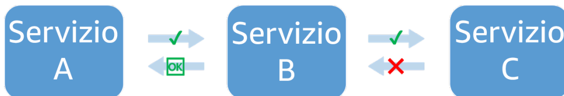
Figura 5. Il servizio C ha esito negativo quando viene chiamato dal servizio B. Il servizio B restituisce una risposta degradata al servizio A.
