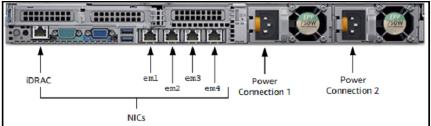
2. イーサネットケーブルを em1 ポートに接続し、インターネットの常時接続を提供します。em1 ポートは、背面で左から右に並ぶ 4 つの物理ネットワークポートの 1 つめのポートです。
