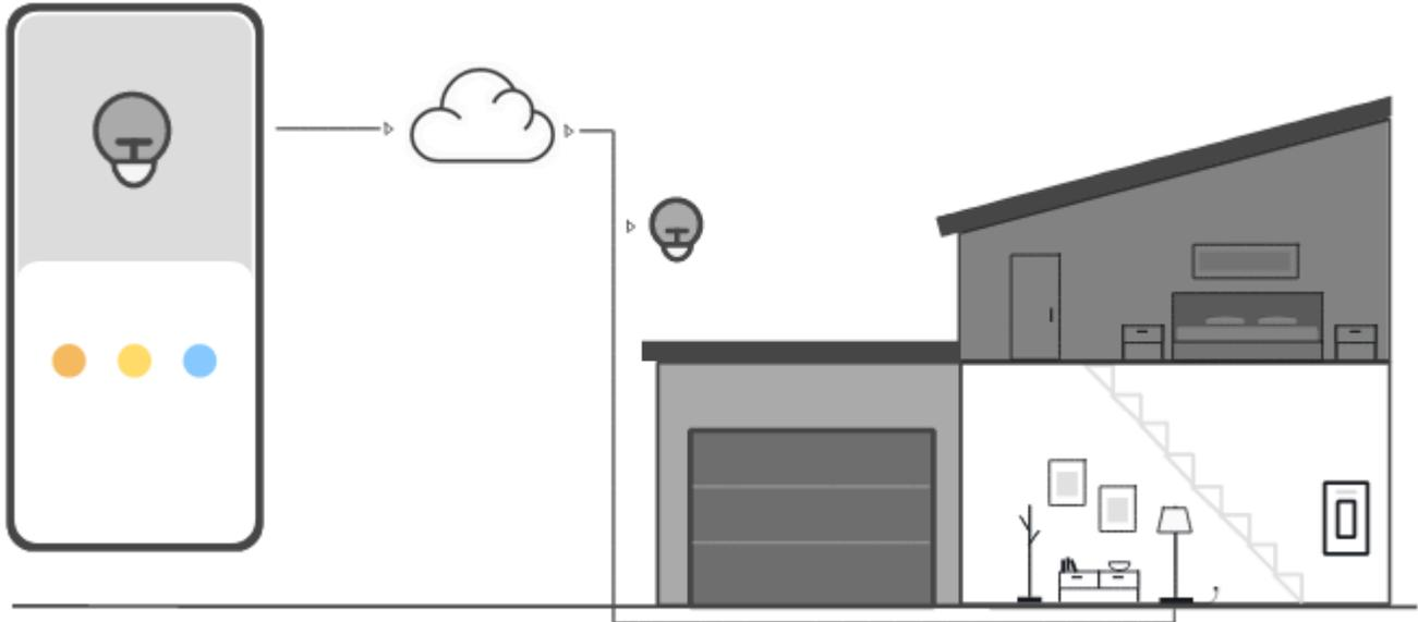
このステップのアニメーションは、 の Device Shadow サービスが制御デバイスとスマートランプのデバイス状態情報 AWS IoT Core を保存する方法を示しています。スマートランプがオフラインの場合、デバイスシャドウは制御デバイスからのコマンドを保存します。
