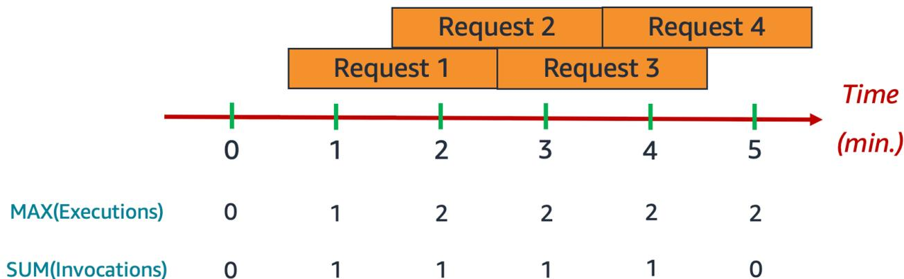
この例では、1 分あたり 1 回の呼び出しを受け取り、各呼び出しの完了までに 2 分かかるとします。オレンジ色の横棒はそれぞれ 1 つのリクエストを表します。この関数に 10 ユニットのプロビジョニングされた同時実行を割り当て、各リクエストがプロビジョニングされた同時実行で実行されるとします。
