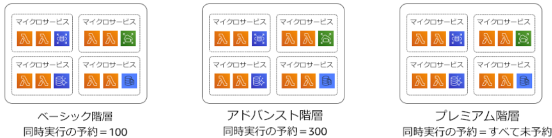
図 24: 同時実行の予約によるテナントパフォーマンスの制御
