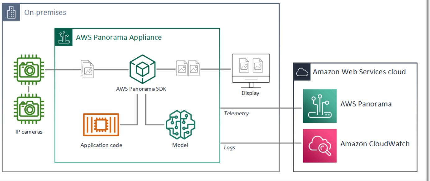
이 예제에서 애플리케이션은 AWS Panorama Application SDK를 사용하여 카메라로부터 비디오 프레임을 가져오고, 비디오 데이터를 전처리하고, 객체를 감지하는 컴퓨터 비전 모델로 데이터를 전송합니다. 애플리케이션은 어플라이언스에 연결된 HDMI 디스플레이에 결과를 표시합니다.
