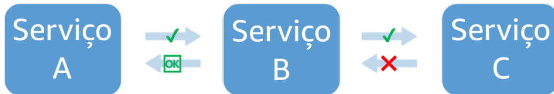
Figura 5: O serviço C falha quando chamado do serviço B. O serviço B retorna uma resposta degradada ao serviço A.
