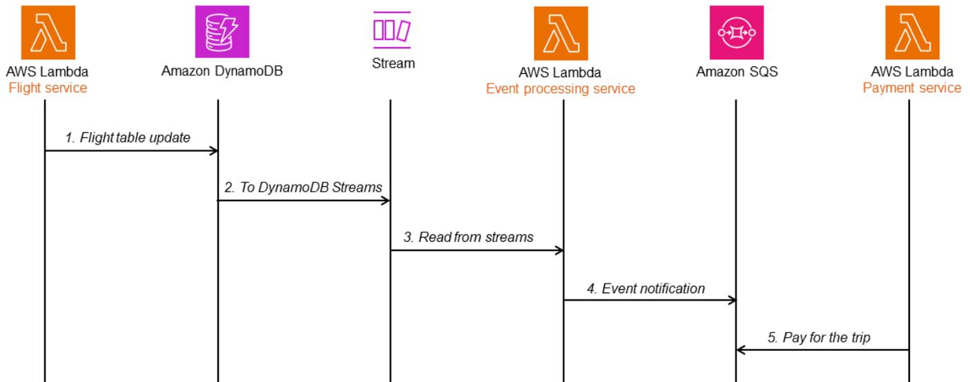
DynamoDB Streams 使用时间排序序列捕获与 DynamoDB 表中项目级更改相关的信息流。
