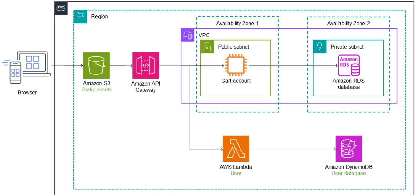
在下图中，购物车服务也已从整体迁移到一个 Lambda 函数中。重构空间中添加了额外的路由和服务终端节点，流量会自动切换到 Lamb Cart da 函数。[Lambda 函数的数据存储由亚马逊管理。](#)[ElastiCache](#)整体应用程序仍与 Amazon RDS 数据库一起保留在 EC2 实例中。
