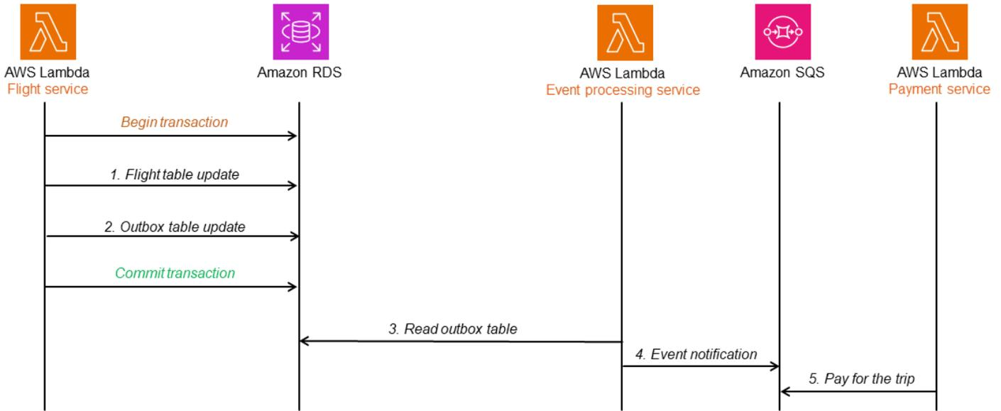
在下图中，事务发件箱架构是使用 Amazon RDS 数据库实现的。当事件处理服务读取发件箱表时，它只识别已提交（成功）事务中的那些行，然后将事件的消息放入 SQS 队列中，由付款服务读取该队列以供进一步处理。这种设计解决了双重写入操作问题，并通过使用时间戳和序列号来持久化消息和事件的顺序。
