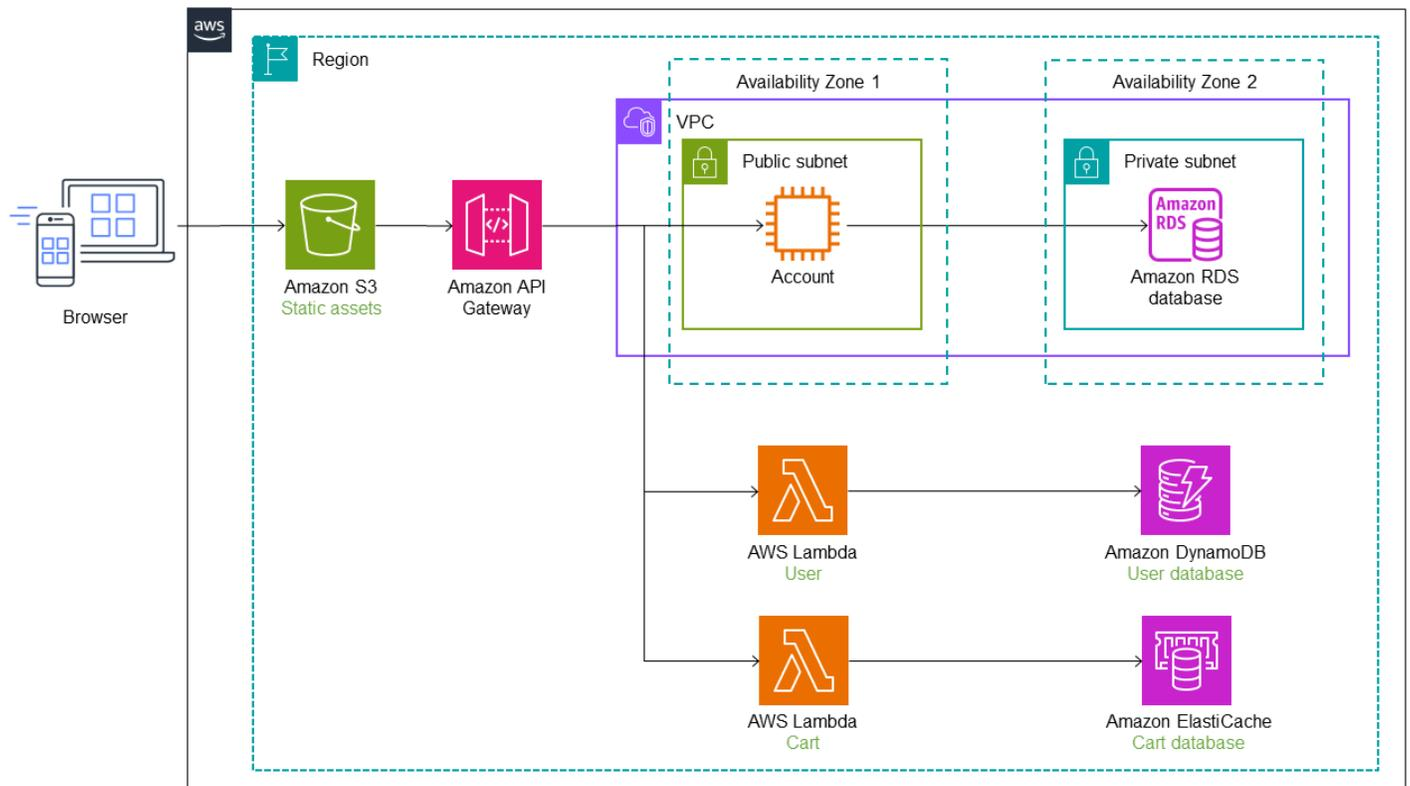
在下图中，最后一个服务（账户）从整体架构迁移到 Lambda 函数中。它继续使用最初的亚马逊 RDS 数据库。新架构现在有三个带有独立数据库的微服务。每种服务使用不同类型的数据库。这种使用专门构建的数据库来满足微服务的特定需求的概念被称为多语言持久性。Lambda 函数也可以用不同的编程语言实现，具体取决于用例。在重构期间，重构空间会自动将流量切换和路由到 Lambda。这可以为您的建筑商节省架构、部署和配置路由基础设施所需的时间。
