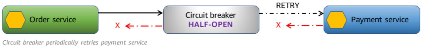
成功呼叫支付服务后，电路将关闭，所有后续呼叫将再次路由到支付服务。
