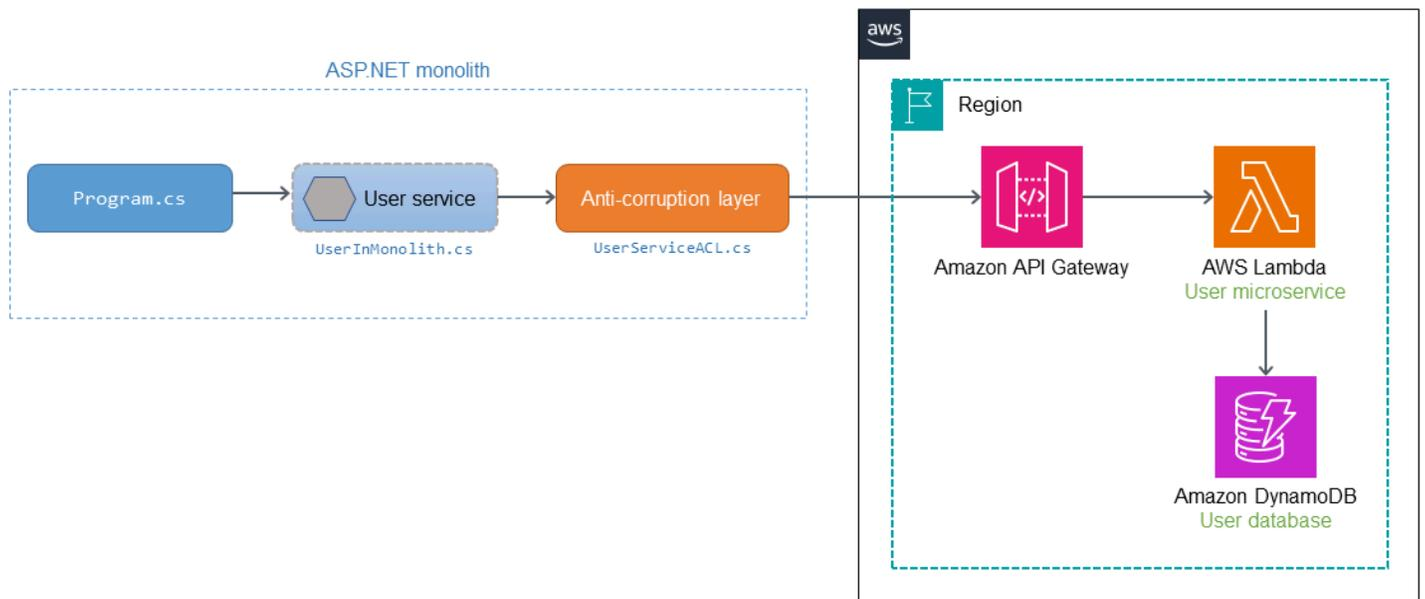
用户微服务从 ASP.NET 单片应用程序中迁移出并部署为 [AWS Lambda](#) 上的函数。对 Lambda 函数的调用通过 [亚马逊 API 网关](#)。ACL 部署在单体中，用于转换调用以适应用户微服务的语义。
