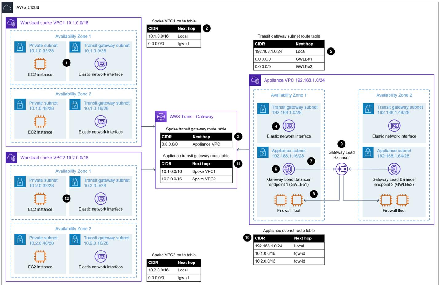
在此用例中，两个分支VPCs托管跨两个可用区的工作负载EC2实例，一个设备VPC托管第三方防火墙设备以进行流量检查。VPCs它们使用相互连接 AWS Transit Gateway。该图显示了可用区 1 Workload spoke VPC1 中的EC2实例向可用区 1 Workload spoke VPC2 中的实例发送数据包时的以下数据包流：
