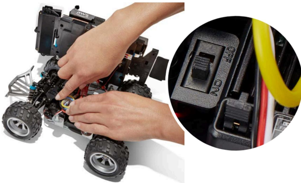
3. 如果在開啟車輛電池時沒有聽到兩聲嗶聲，請確保電池已充滿電。將車輛電池的白色連接器纜線插入其充電轉接器，可以根據其紅色和綠色 LED 指示燈來區分運算模組的配接器。將轉接器連接到充電纜線，然後將其插入電源插座。當車輛電池充電轉接器上的紅色和綠色指示燈都亮起時，表示電池仍需要充電。
