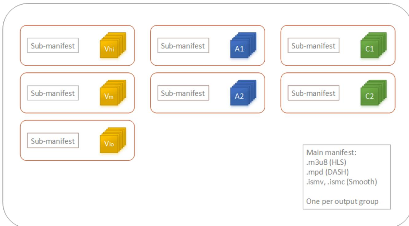
單一工作可產生零到多個獨立作業的檔案以及零到多個串流套件。若要建立一個以上的獨立檔案，請將單一檔案輸出群組新增到您的任務，然後將多個輸出新增到該輸出群組。若要建立一個以上的串流堆
